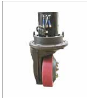
Приводное колесо с вертикальным АС приводом
