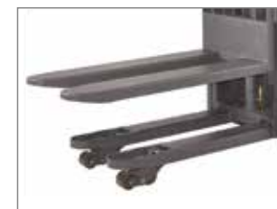
Опция – подъем опорных консолей для обработки двух паллет
