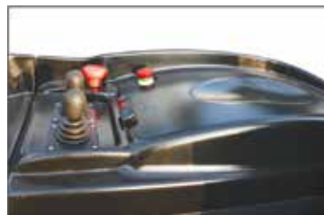
Точное и удобное управление гидравликой двумя многопозиционными джойстиками
